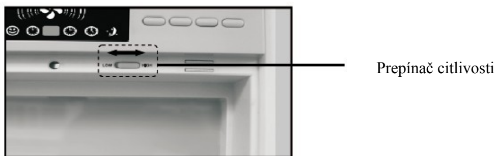
Obr. 18 – prepínač citlivosti senzorov kvality ovzdušia
